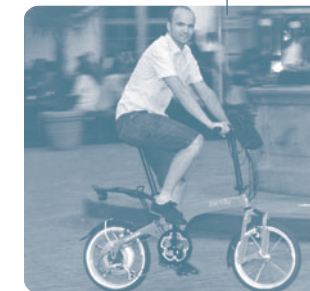
Das Birdy von Riese und Müller als Faltpedelec mit Heckantrieb und Kraftsensor
