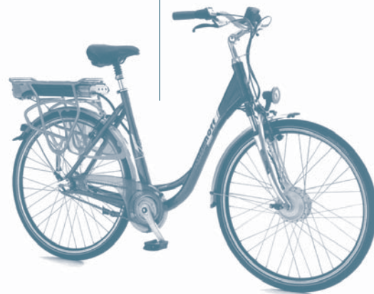
Das Jubilee Pedelec F von Kalkhoff mit Frontantrieb und Kraftsensor
