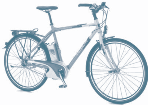
Das Pro Connect von Kalkhoff mit Mittelantrieb und Kraftsensor
